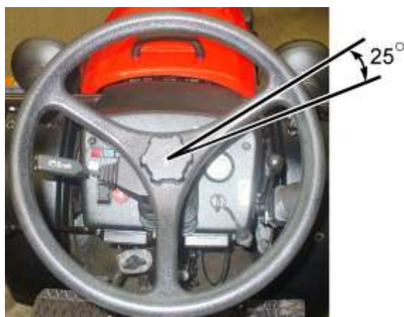
Рисунок 6.4.8 – Проверка люфта рулевого колеса
