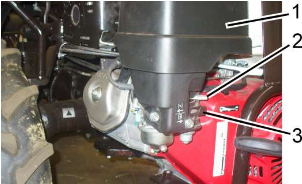
Рисунок 2.18.1 – Управление краном топливного бака
