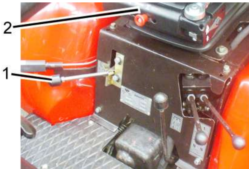
Рисунок 2.10.1 – Управление блокировкой дифференциала заднего моста 1 – тяга; 2 – сидение оператора
