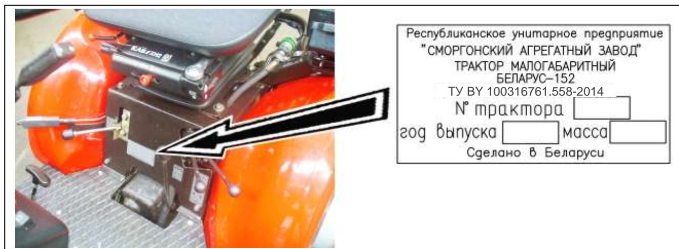
Рисунок 1.5.1 – Место расположения фирменной маркировочной таблички трактора
