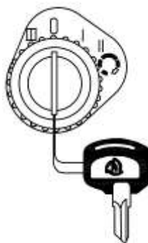
Рисунок 2.2.2 – Схема положений выключателя стартера и приборов
