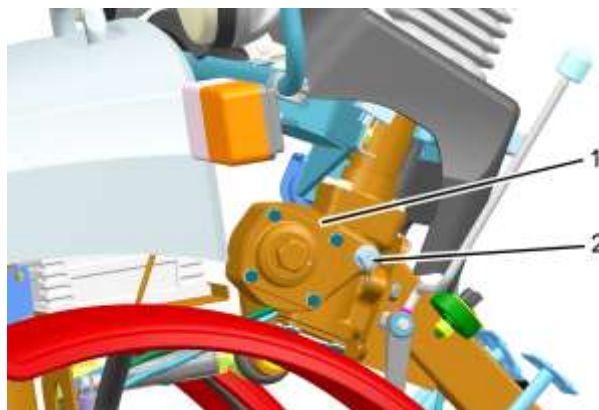
Рисунок 6.4.11 – Схема регулировки сходимости передних колес 1 – корпус рулевого управления; 2 – контрольно-заливная пробка
