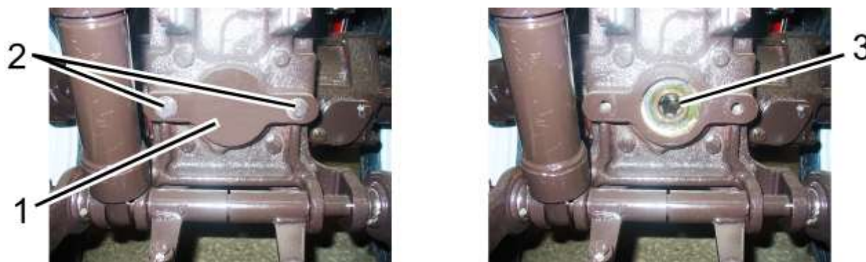
Рисунок 4.2.1 – Снятие защитного колпака и замена хвостовика заднего ВОМ 1 – защитная пластина; 2 – болты; 3 – хвостовик ВОМ.
