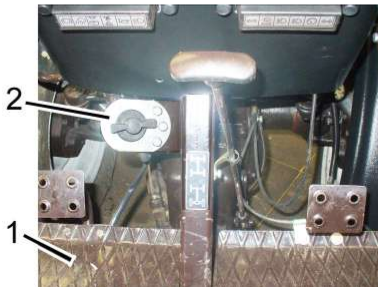
Рисунок 2.7.1 Выключатель АКБ 1 – площадка для ног; 2 – выключатель АКБ
